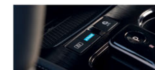
UNE CONDUITE ÉLECTRIQUE PLUS SOUPLE GRÂCE À e-PEDAL STEP Découvrez une façon plus intuitive de conduire grâce à e-Pedal Step. Cette technologie Nissan vous permet d'accélérer et de décélérer efficacement avec la seule pédale d'accélérateur, à des vitesses supérieures à 10 km/h. Utilisez la pédale de frein pour les freinages plus appuyés et les arrêts complets.
